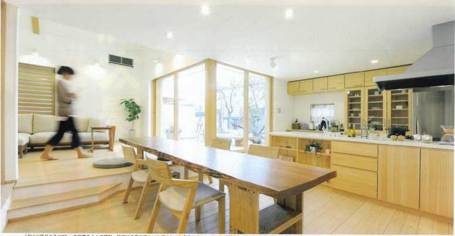
LDには所どころに28cmの段差をあえて設計。無垢材の床の温もりを感じながら家族やゲストがラフに腰掛けて寛ぐことができる。天井高2.35mのダイニングから5mのダイナミックな吹抜けを設けたりリビングへ移動すると、いっそうの広さと開放感が感じられる。コーナーにある大きな全開放窓の外にはデッキが広がり、心地よい自然の風と光が舞い込んでくる。人の動きが多い1階の床には、ヒノキや松など耐久性の高い素材を使用
